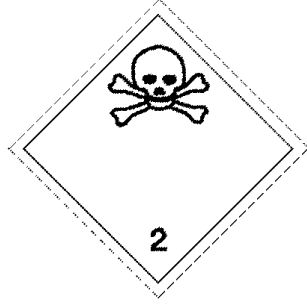
(No. 2.3) Zehirli gazlar Sembol (kafatası ve çapraz kemikler): siyah; Zemin: beyaz; Alt köşede "2" rakamı
